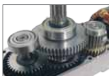
Thermo treated gears on rotating arms supported by ball bearings Ingranaggi trattati termicamente e calettati su alberi rotanti supportati da cuscinetti
