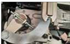
Adjustable mechanical stop in opening and closing Stop meccanici regolabili in entrambe le direzioni.
